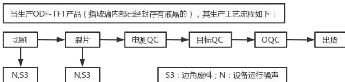
图 2.4-3 切灌段生产工艺流程及产排污图
