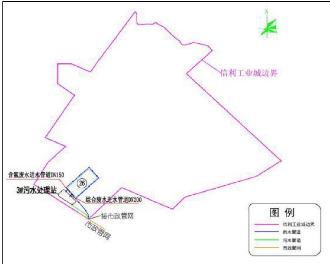
图 4.1-2 26 号厂房的污水、雨水管网图
